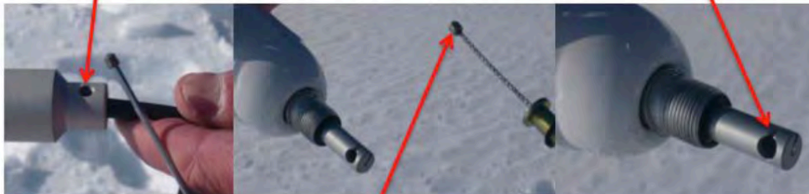
Support de fixation de l'embout du câble dans le système de percussion
